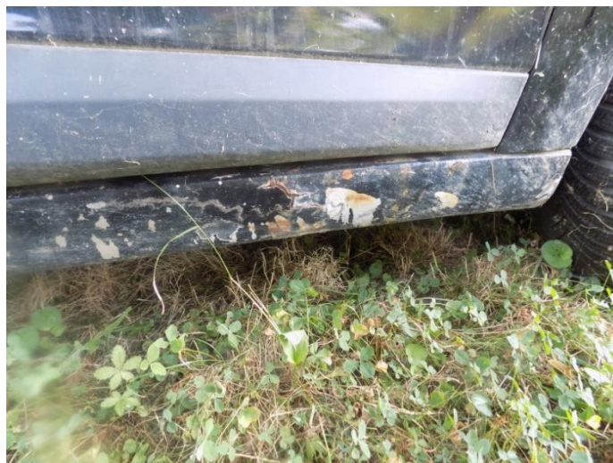
2. Renault Megane – oštećenje pragova
